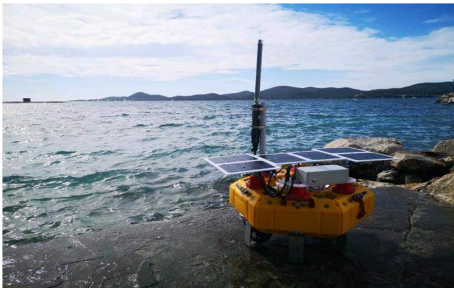
Rysunek 1.1. Smart Drifter Cariddi, zaprojektowany przez zespół MDM (Fairchild, 2022, s. 1)
