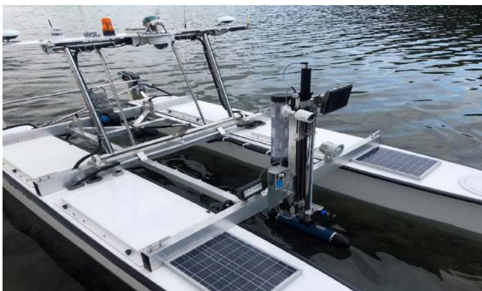
Rysunek 2.4. Bezzałogowa platforma nawodna HydroDron-1 z głowicą sondy wielowiązkowej w górnym położeniu i czujnikiem dźwięku zamontowanym nad głowicą – widok skośnie z przodu (foto: A. Stateczny)
