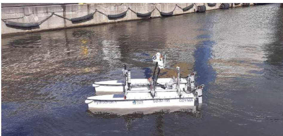
Rysunek 2.6. Bezzałogowa platforma nawodna HydroDron-1 w trakcie pomiarów przy nabrzeżu Rotterdamskim w porcie morskim w Gdyni wykonanych w maju 2023 r. (foto: A. Stateczny)
