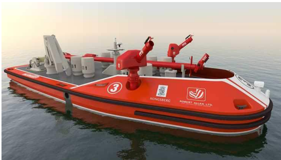
Rysunek 1.2. Zdalnie sterowana łódź strażacka (KONSBERG, 2023)
