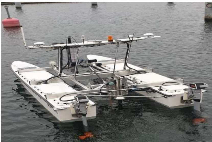
Rysunek 2.5. Bezzałogowa platforma nawodna HydroDron-1 – widok od rufy na silniki elektryczne (foto: A. Stateczny)
