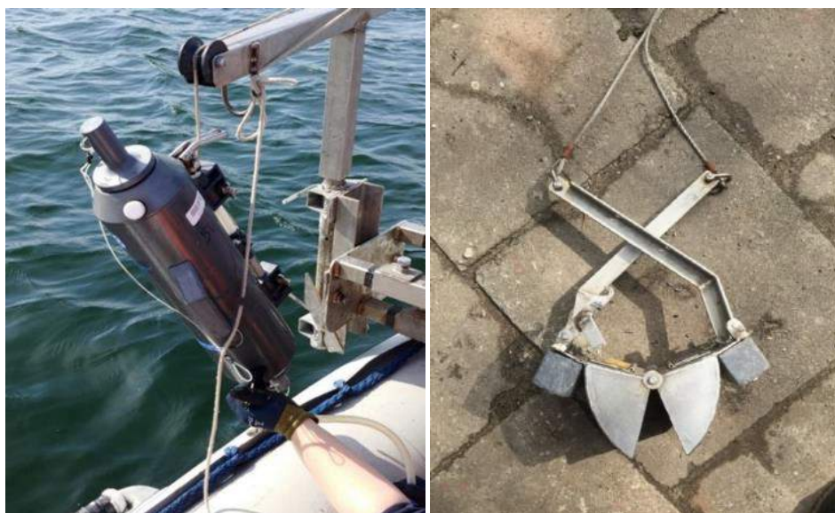
Rysunek 3.3. Przyrządy wykorzystywane do pobierania: próbek wód morskich w basenach Portu Gdynia – batometr (po lewej) oraz próbek osadów morskich – czerpacz Van Veena (po prawej) (foto: B. Lednicka)
